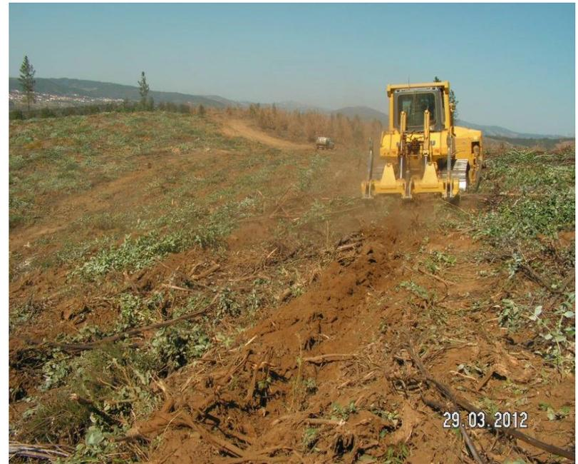
**Bulldozer de 170 cv com 1 – 3 dentes, 80 cm de profundidade**
