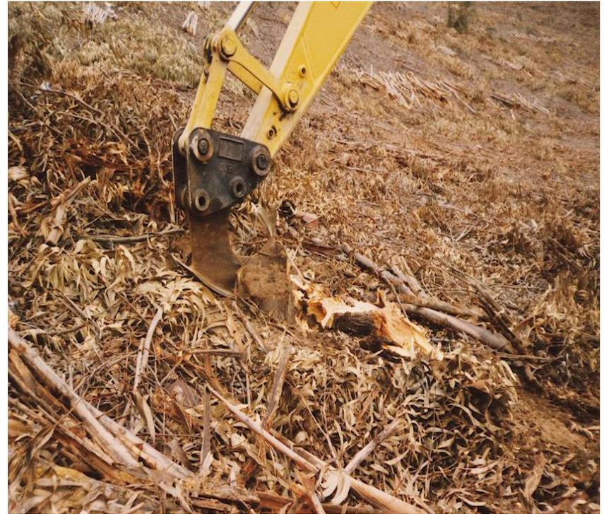
**Destroçar deixando espalhadas pequenas partes do cepo, cortar bem as raízes sem alterar perfil do solo**
